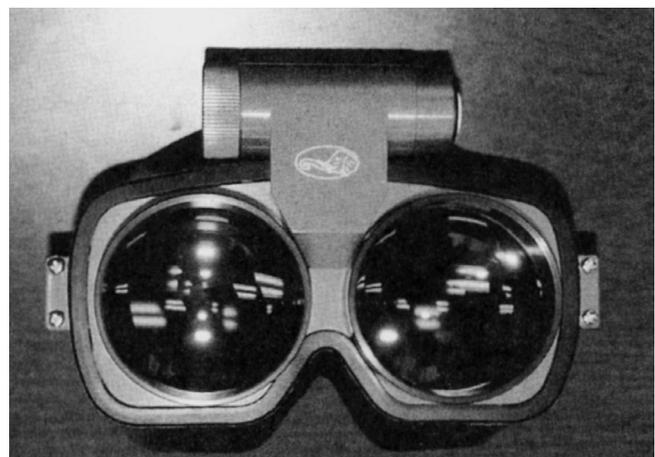
Fig. 7 著者と永島医科(株)で共同開発したLED照明とリチウム電池を用い、コードと電池ボックスのない一体型の新しい Frenzel 眼鏡
